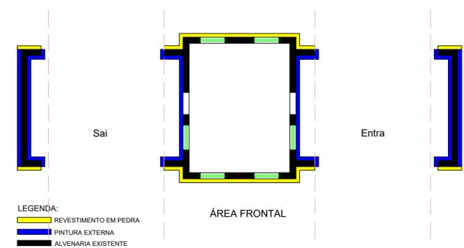
PLANTA BAIXA – DETALHE DE LOCALIZAÇÃO DE PINTURAS E REVESTIMENTOS
