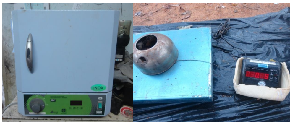
Figura 13 - Retirada do recipiente de 2 L da estufa e pesagem para determinação do teor de umidade.
