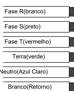
Detalhe Coloração fiação dos alimentadores
