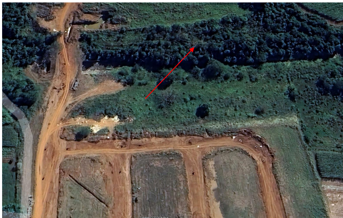
Figura 6.9 – Loteamento sendo implantado. Notar a abertura das ruas e obras da travessia sobre curso d'água, com a implantação da Avenida 1. Notar Vegetação em APP (Área Verde 2) que será preservada em Área Verde.
