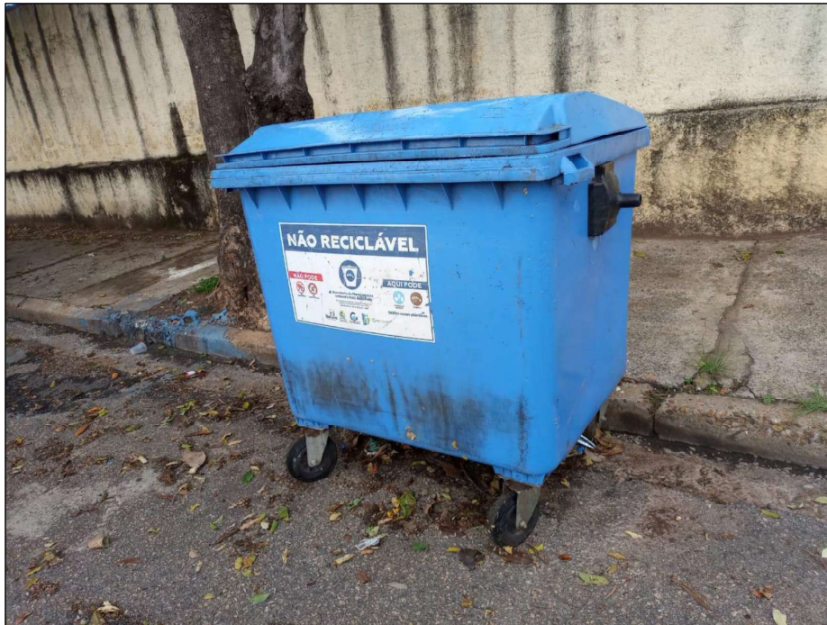
Figura 14 - Contêiner de PEAD de 1.000 litros, disponibilizado para coleta em áreas rurais.
