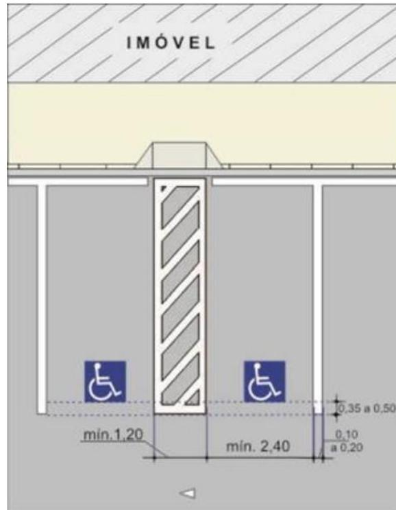
Figura 5 – Vaga paralela ao meio-fio deficiente físico.
