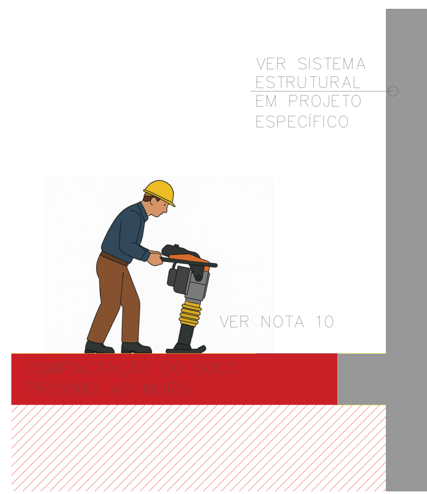
4 COMPACTAÇÃO MANUAL NAS ADJACÊNCIAS DO MURO SEM ESCALA
