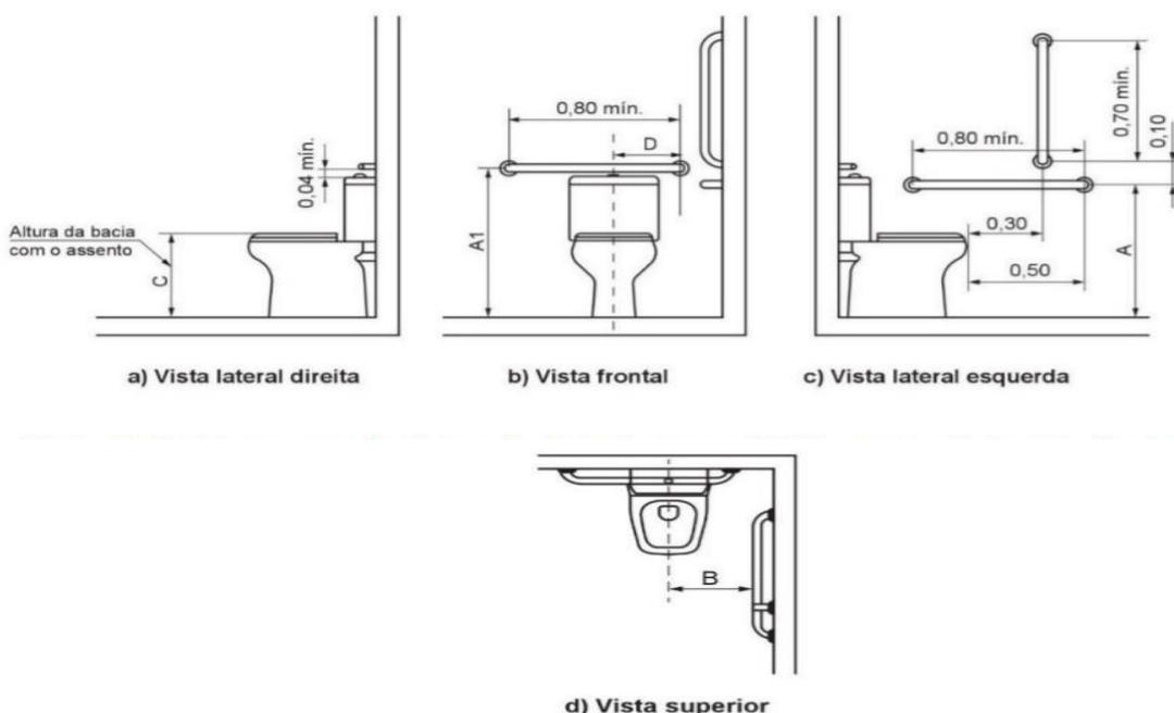
Figura 17. Posicionamento das barras de apoio do vaso sanitário com parede lateral e fundos
