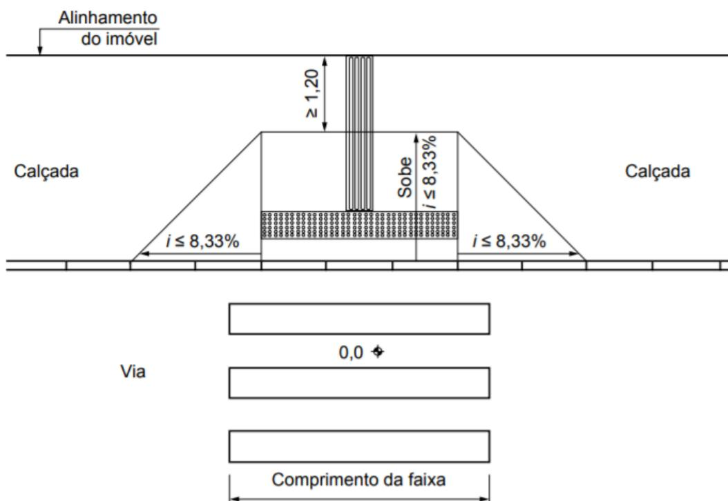
Não pode haver desnível entre o término do rebaixamento da calçada e o leito carroçável. Em vias com inclinação transversal do leito carroçável superior a 5 %, deve ser
