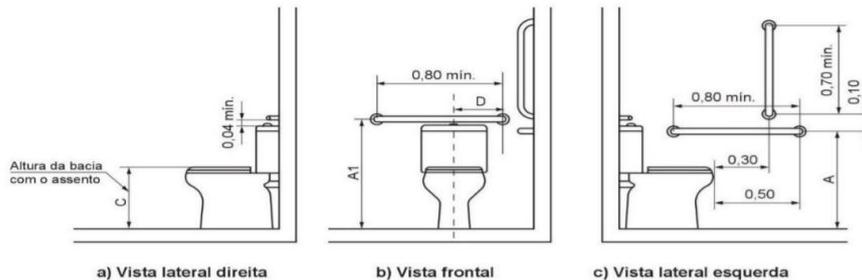
Figura 16. Posicionamento das barras de apoio do vaso sanitário com parede lateral e fundos
