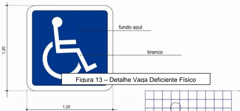
Figura 13 – Detalhe Vaqa Deficiente Físico
