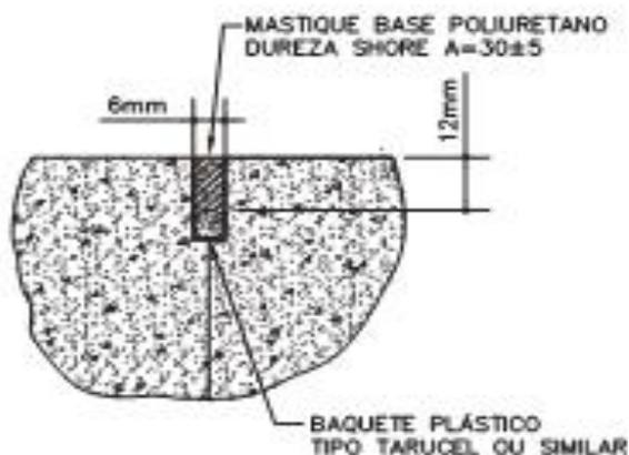
SELANTE PARA JUNTA DE CONSTRUÇÃO (C)
