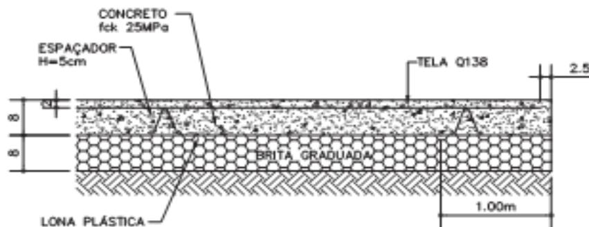
NOTA: INTERROMPER A LONA À 1.00m ANTES DA JUNTA DE PERÍMETRO
