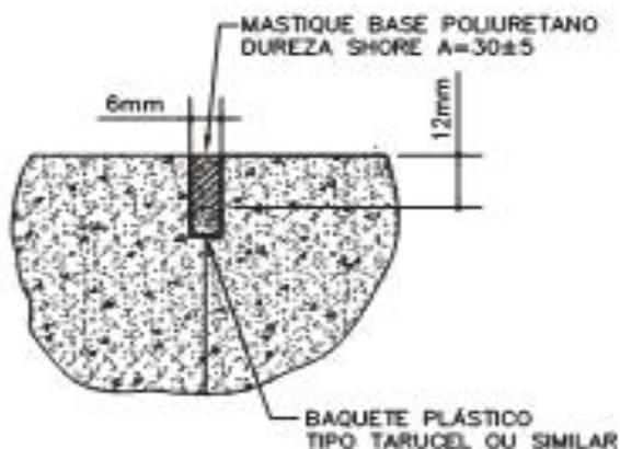
SELANTE PARA JUNTA DE CONSTRUÇÃO (C)
