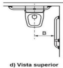
Figura 17. Posicionamento das barras de apoio do vaso sanitário com parede lateral e fundos
