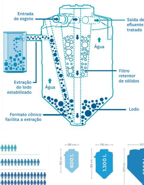
**Figura 2. Desenho Esquemático do Biodigestor**
