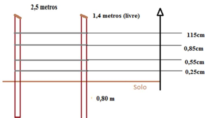
**Figura 3. Desenho esquemático do cercamento**
