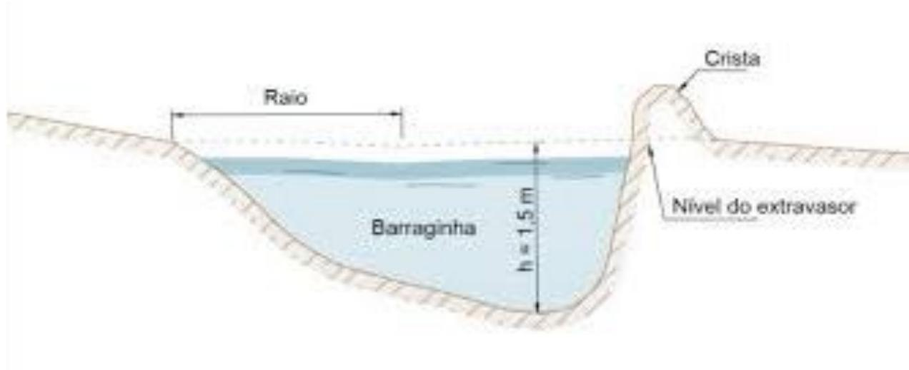
**Figura 1:** Croqui do perfil da bacia de Infiltração.
