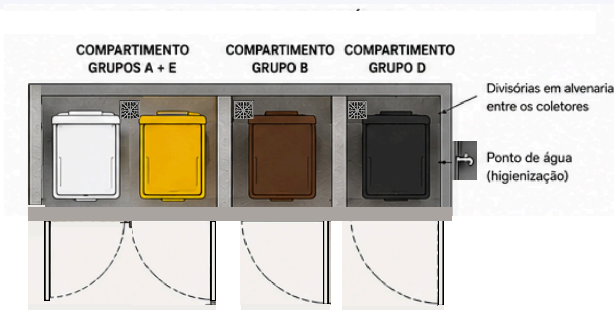
Figura 03: Exemplo de planta baixa do abrigo de resíduos que deve ser dimensionada de acordo com a demanda de cada estabelecimento. Imagem elaborada pelos autores, Junho 2026.
