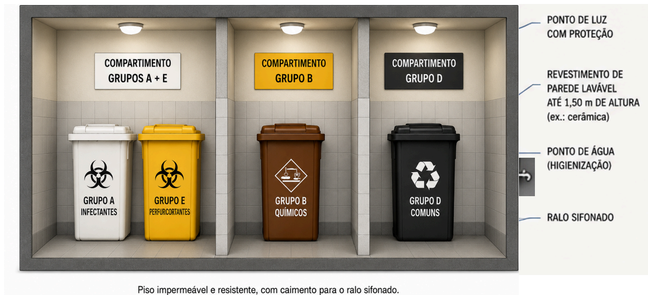
Figura 05: Representação da vista de um abrigo de resíduos com todos os detalhes exigidos. Imagem elaborada pelos autores, Junho 2026.
