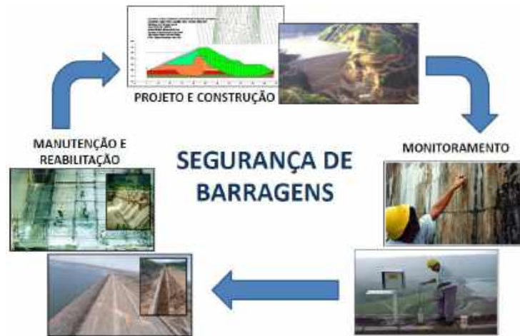
Figura 8 - Esquema da Segurança de Barragens
