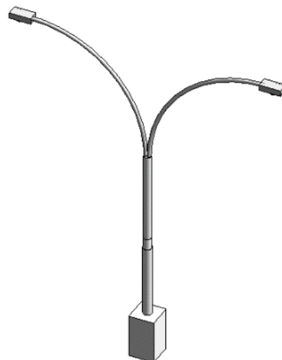
Figura 55 - Poste Telecônico Engastado com Luminária Preta 50W - H=4,00 e P=1,60 m
