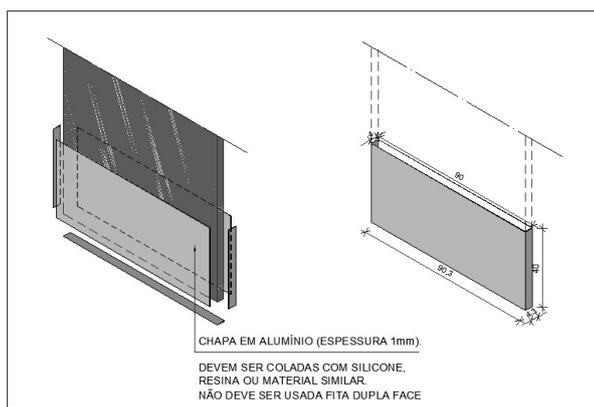
Figura 3 - detalhe chapa metálica para portas de madeira
