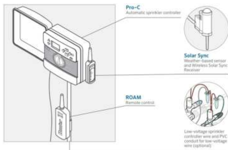
Figura 47 - Instalação do Controlador
