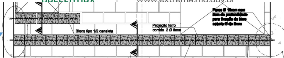
Figura 7 – Fixação das vergas e contravergas.
