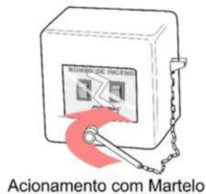
Figura 11 – Botoeira bomba de incêndio.
