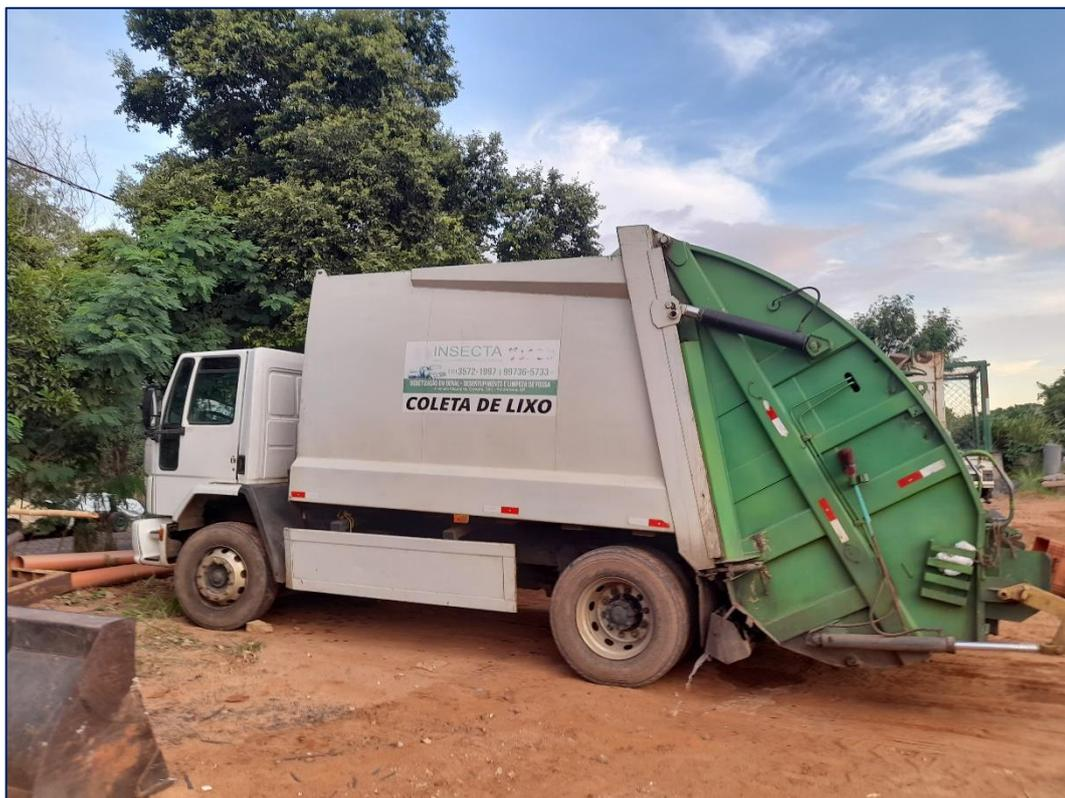
Foto 82 – Caminhão compactador utilizado para a coleta dos resíduos domiciliares
