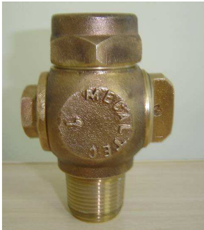
Figura 5.1. Estação Pitométrica (EP).
