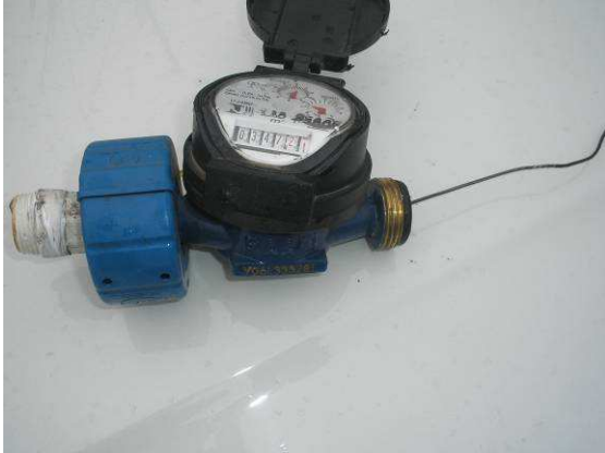
Figura 68. Hidrômetro com arame.
