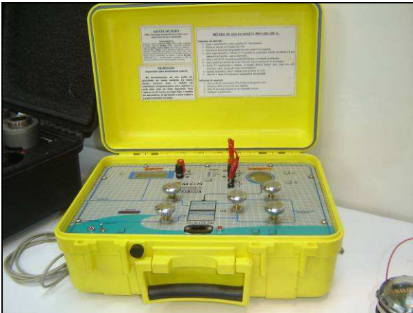
Figura 40. Equipamento que contém um sensor de diferencial de pressão.
