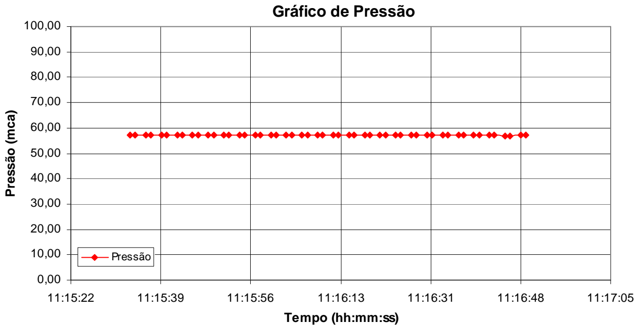
Figura 63. Variação da pressão na adutora de água tratada de diâmetro 400mm situada no recalque da ETA para o Reservatório Jardim Pacaembu, na condição das Bombas 01 e 03 operando em conjunto ( P_{m\acute{e}dia} = 57,1 mca) com amperagem máxima (175A).
