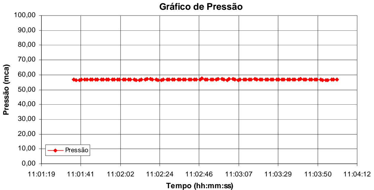
Figura 59. Variação da pressão na adutora de água tratada de diâmetro 400mm situada no recalque da ETA para o Reservatório Jardim Pacaembu, na condição das Bombas 02 e 03 operando em conjunto ( P_{média} = 56,8 mca) com amperagem máxima (175A).
