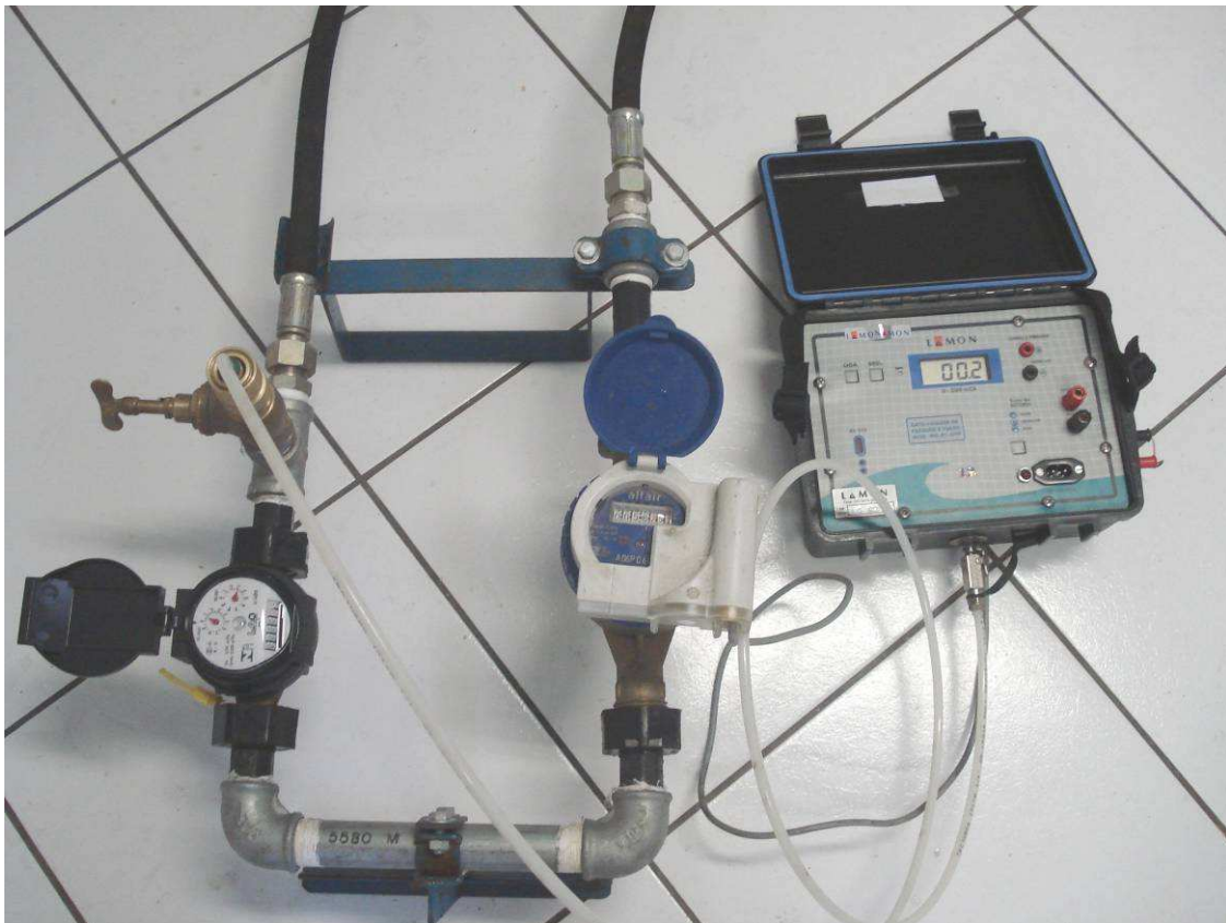
Figura 23. Equipamento data-logger de pressão que foi utilizado para medir pressão no sistema de abastecimento do município de Vargem Grande do Sul.
