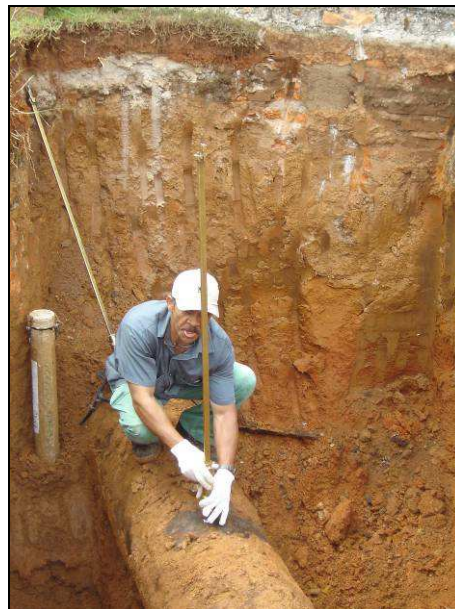
Figura 35. Medição do diâmetro real da adutora com o equipamento Calibre.
