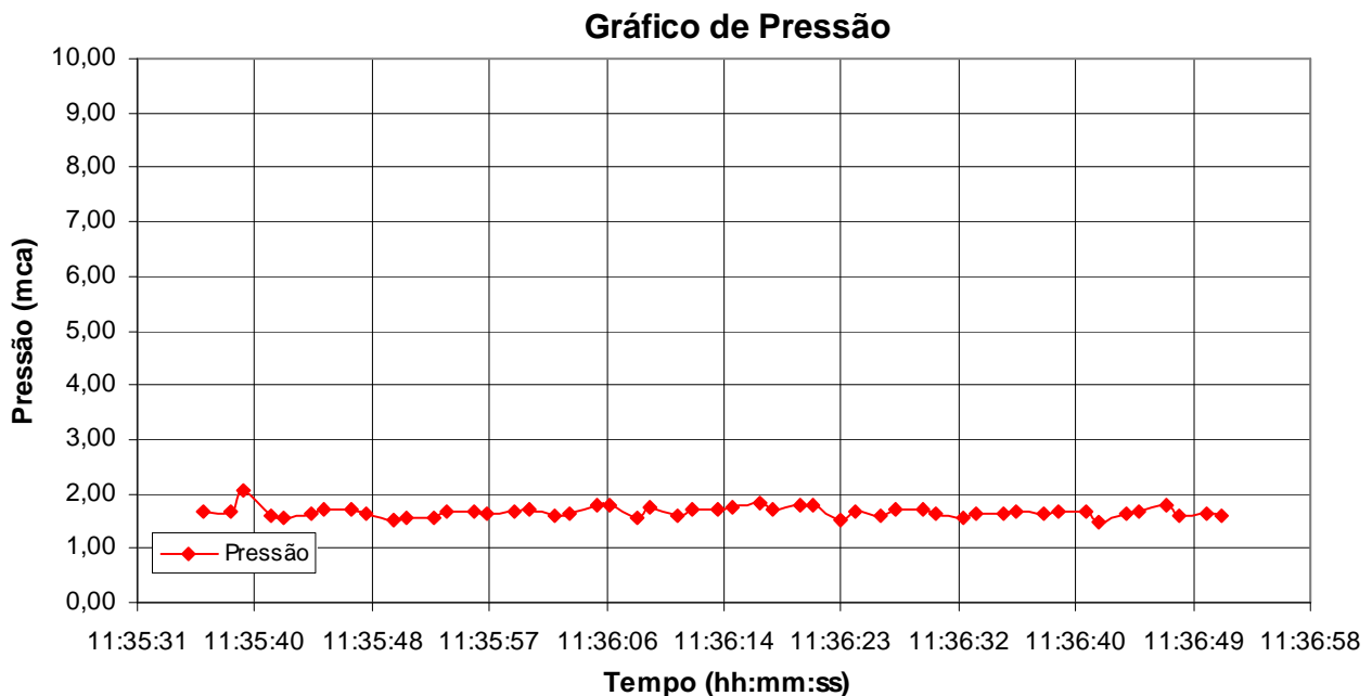
Figura 82. Variação da pressão na adutora de água tratada de diâmetro 400mm situada na chegada do Reservatório Jardim Pacaembu vinda da ETA, na condição das Bombas 02 e 03 operando em conjunto ( P_{média} = 1,7 \text{ mca} ) com amperagem (150A).
