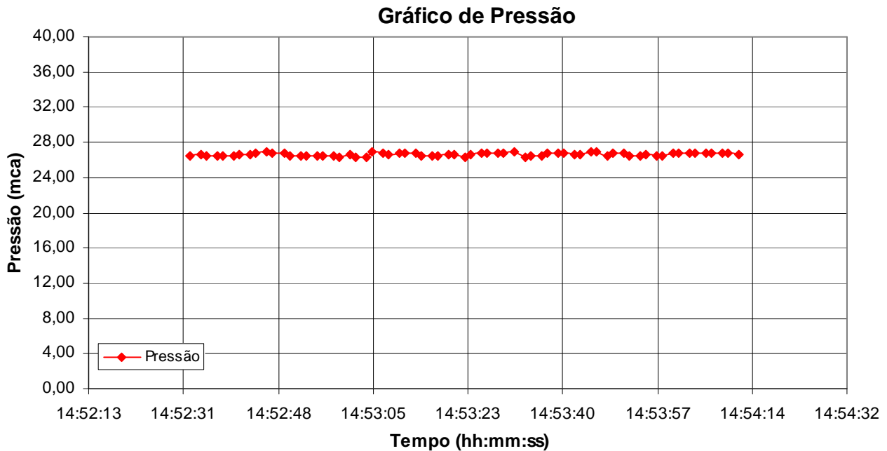
Figura 99. Variação da pressão na adutora de água tratada de diâmetro 200mm situada no recalque do Jardim Pacaembu (Central) para o Jardim Paulista, na condição da Bomba 01 operando isoladamente ( P_{m\acute{e}dia} = 26,6\text{mca} ).
