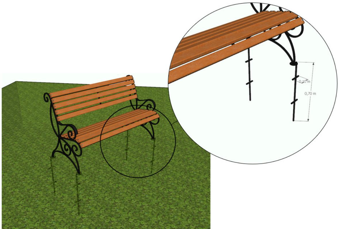
*Figura 18 – Detalhe de fixação dos bancos no parque*
