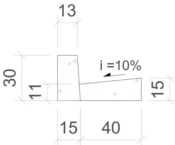
*Figura 11 – Dimensões (centímetros) da guia e sarjeta padrão PMSP*
