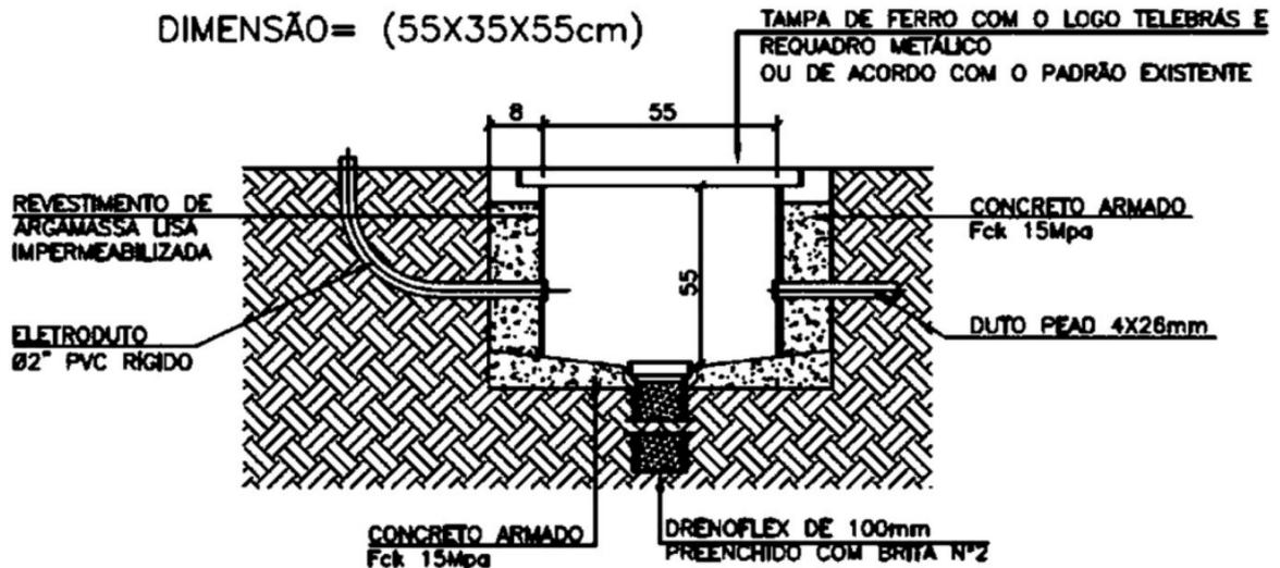
Figura 15 – Caixa subterrânea de concreto tipo R1
