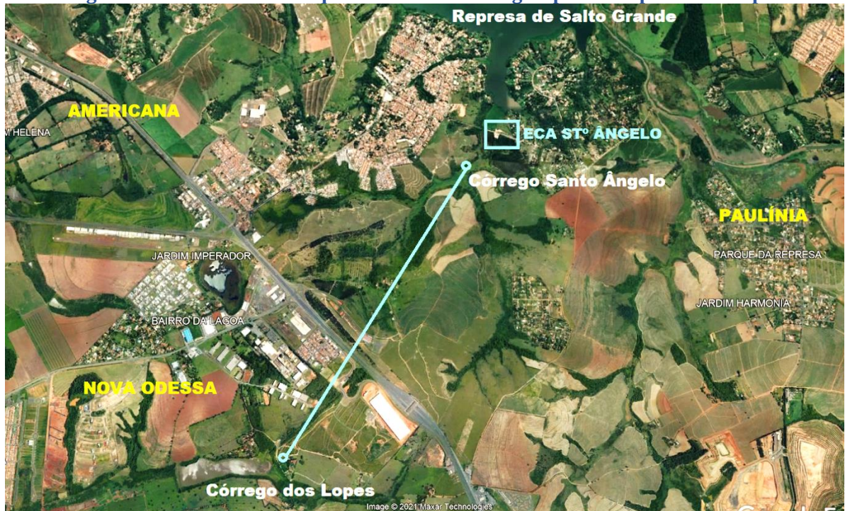
Figura 10 - Sistema de recalque da ECA Santo Ângelo para a Represa dos Lopes
