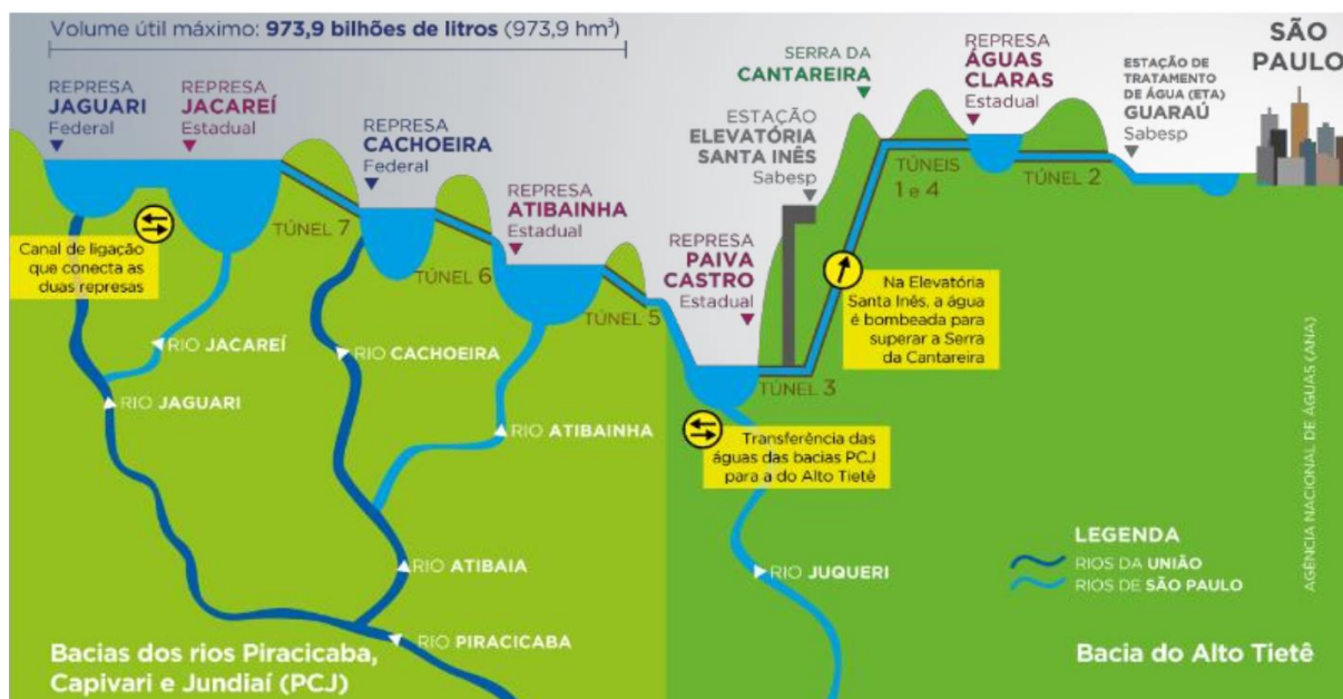
Figura 18 - Esquema Sistema Cantareira de Captação de Água – Representação Gráfica
