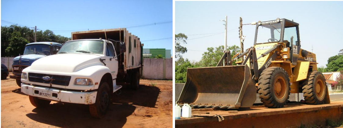
CAMINHÃO BASCULANTE E PÁ-CARREGADEIRA PARA RESÍDUOS DA CONSTRUÇÃO CIVIL.
