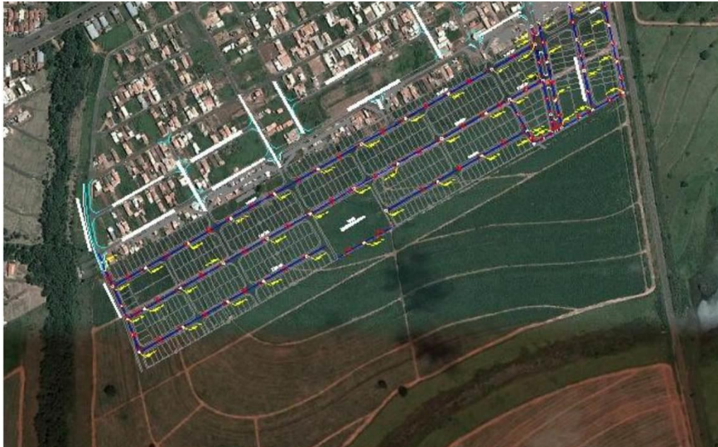
FIGURA 105 - Esquema proposto para manejo de esgotamento sanitário do loteamento Jd. Ilha do Sol
