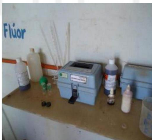
FIGURA 66 – Localização e equipamentos para análises diárias de flúor e cloro residual no Recanto das Águas
