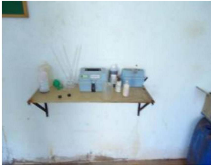
FIGURA 74 – Localização e equipamentos para análises diárias de flúor e cloro residual no sistema Lote 76
