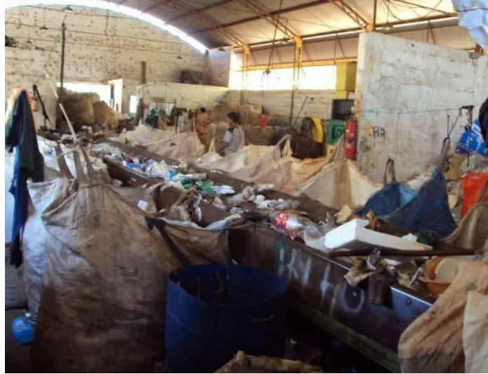
FIGURA 205 – Esteira de separação dos resíduos
