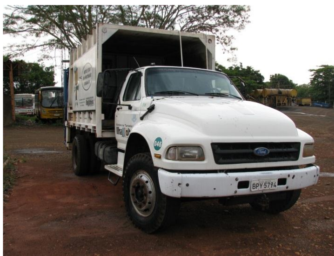
Figura 16 – Fotografia do caminhão coletor compactador FORD F-12000 ano 1994.(Reserva)
