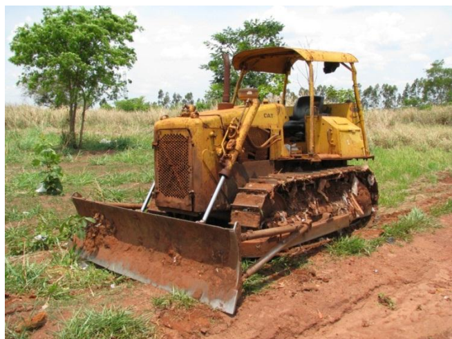
Figura 25 – Fotografia da Máquina esteira responsável pelo serviço de cobertura dos resíduos no aterro sanitário.
