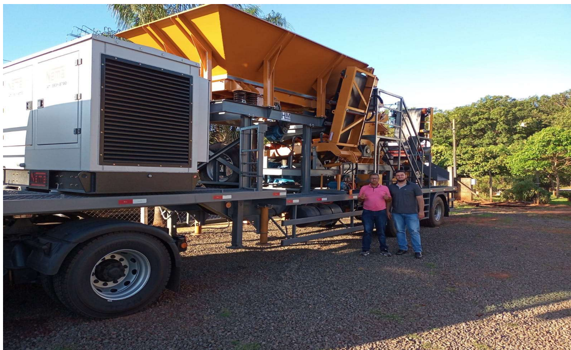
FOTO 01- USINA MÓVEL DE RECICLAGEM DA CONSTRUÇÃO CIVIL (RCC)
