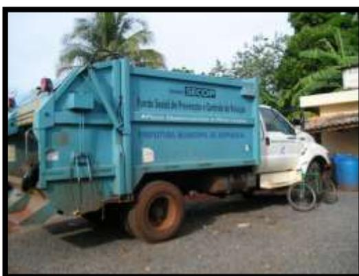
**Figura8:** CAMINHÃO COLETOR-COMPACTADOR
