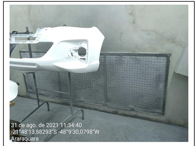
**Figura 5:** Empresa de pequeno porte de funilaria e pintura de veículos com destaque para cabine de pintura e sistema de controle da poluição do ar
