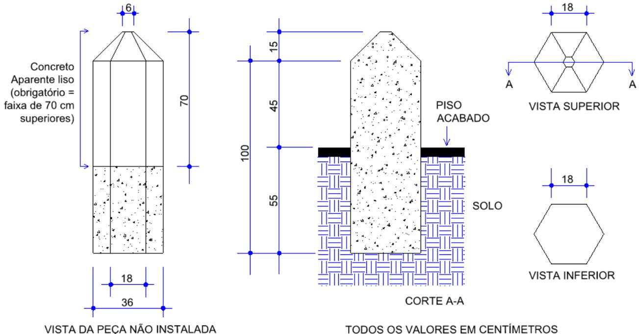
O balizador terá parte engastada no solo e parte aparente conforme apresentado no desenho acima.
