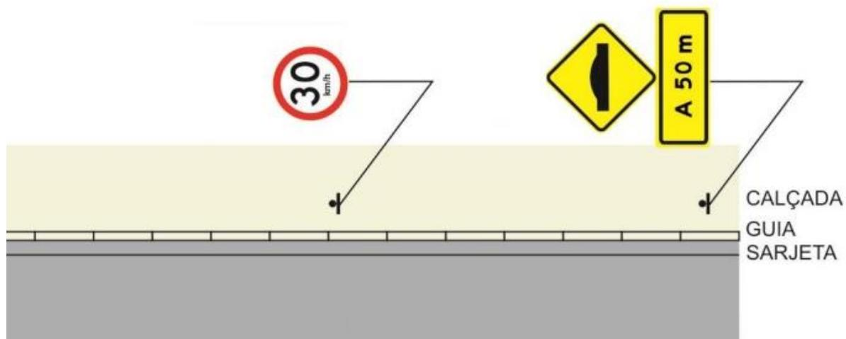
**Figura 6:** Croqui ilustrativo dos elementos da sinalização vertical complementar a ser implantado em conjunto com a lombada ou lombofaixa a critério da SMTTMU.
