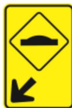
**Figura 2:** Layout da placa a ser utilizada em ambos os lados da lombada tipo A.
