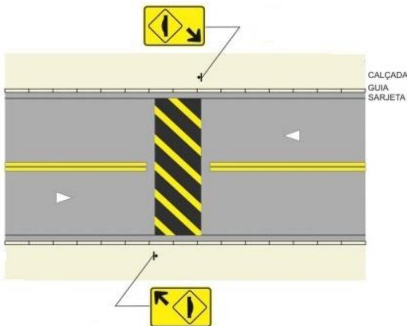
**Figura 3:** Croqui ilustrativo de lombada tipo A com todos os elementos a serem implantados. A figura retrata uma via com operação em mão dupla.
