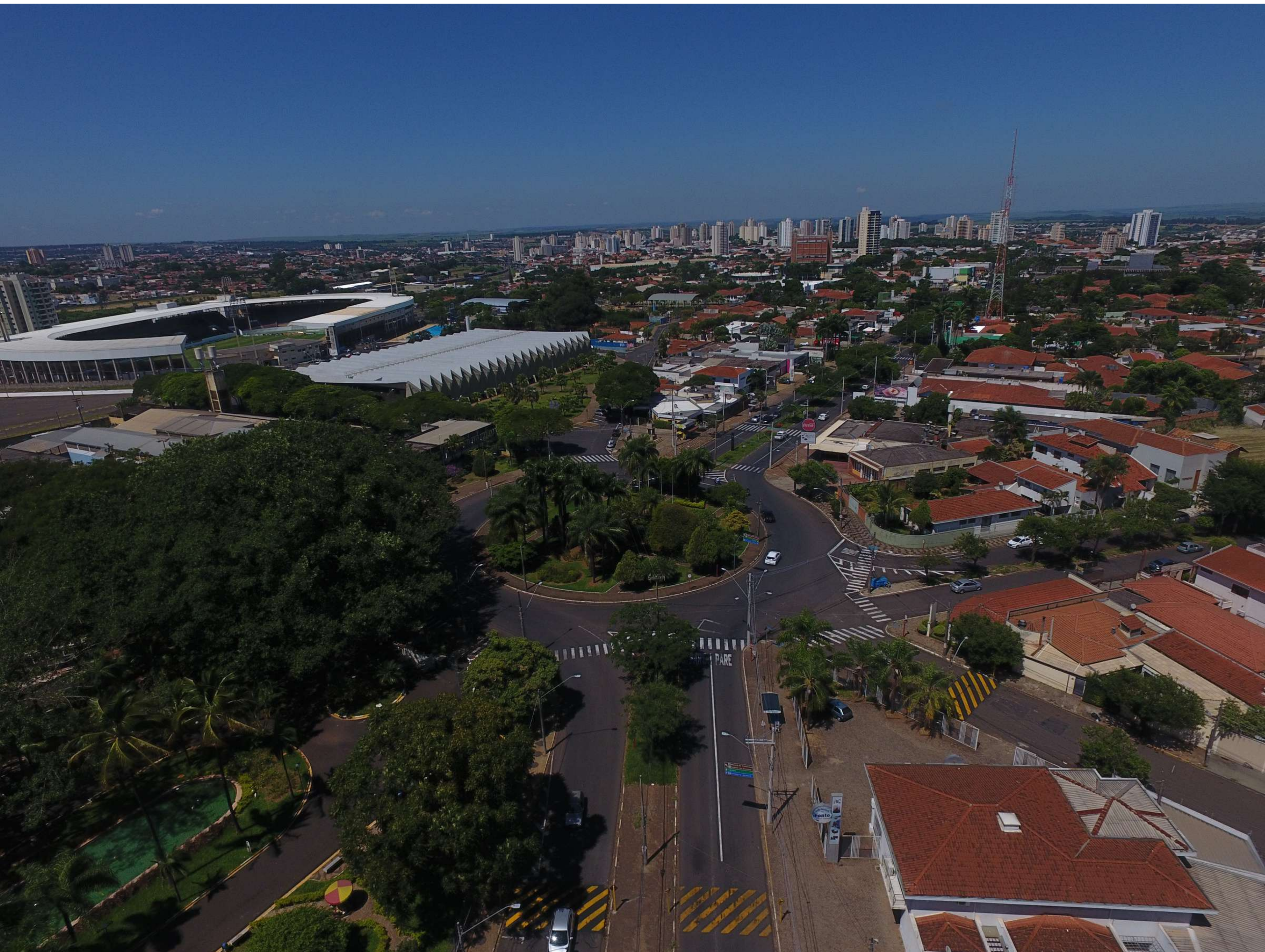
Figura 22 – Divisor de águas entre as Bacias do Ribeirão das Cruzes (afluente Córrego do Marivan) e do Ribeirão do Ouro (afluente Córrego da Servidão). À esquerda, vê-se O Gigantão e o Estádio da Fonte Luminosa, para onde as águas pluviais desaguam para o Córrego da Servidão(Canalizado) e depois para o Ribeirão do Ouro. Fonte: Autores.
