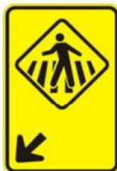
**Figura 4:** Layout da placa a ser utilizada em ambos os lados da lombofaixa.
