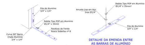
DETALHE DA CONEXÃO DAS BARRAS DE ALUMÍNIO ONDE HOUVER SUBIDA OU DESCIDA
