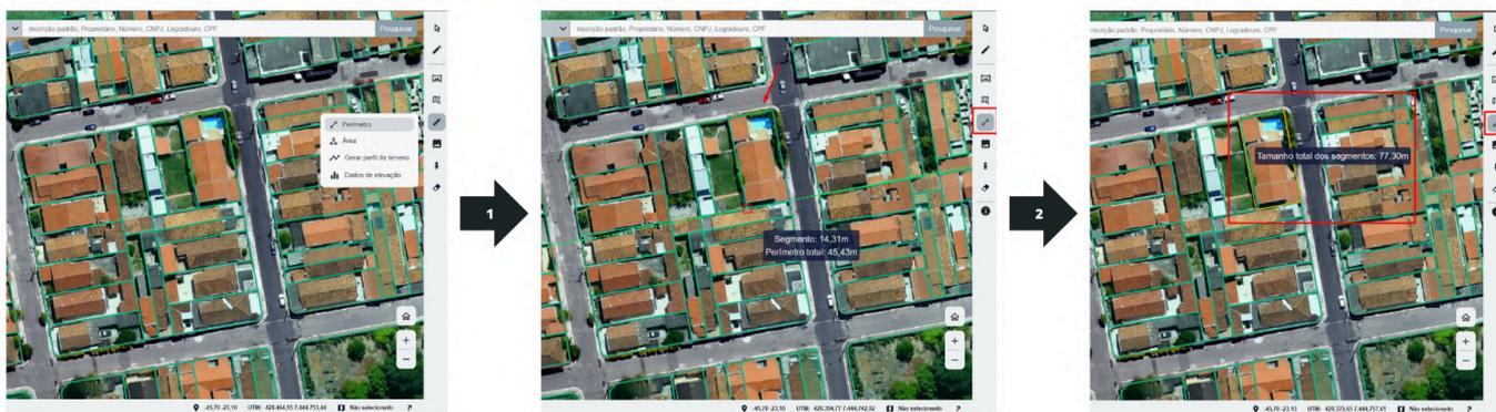
**Figura 38:** Passo a passo para medição do perímetro.
