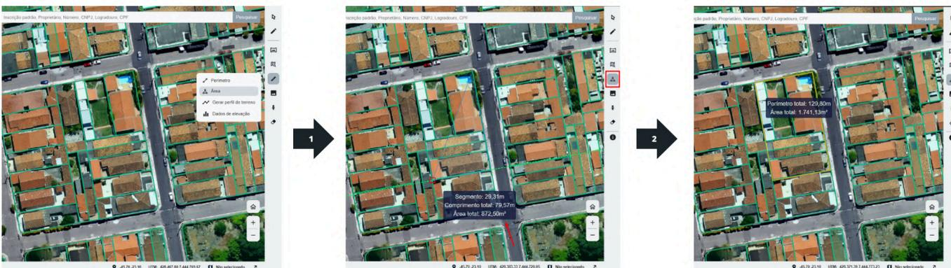
**Figura 39:** Passo a passo para medição de área.
