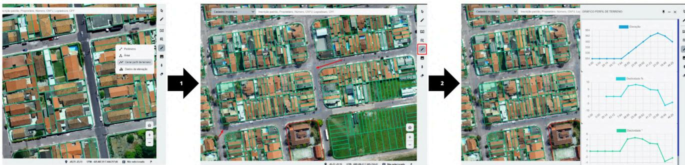
Figura 40: Passo a passo para uso do perfil de terreno.
