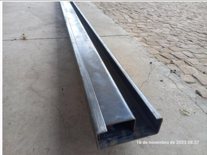
Perfil metálico utilizado para no reforço estrutural da cobertura.
