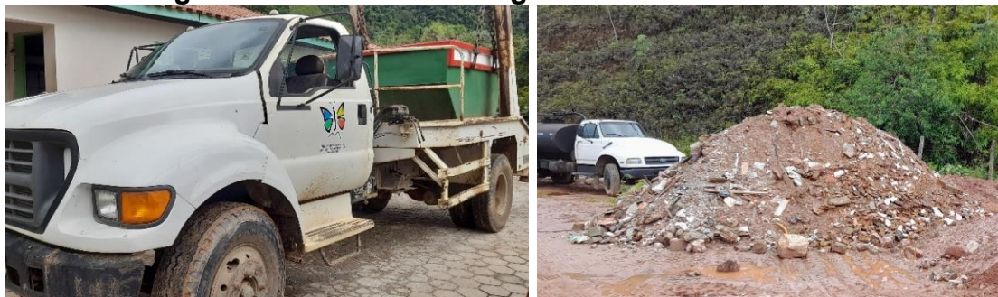
Figura 18 – Caminhão Poliguindaste e Bolsão de RCC
