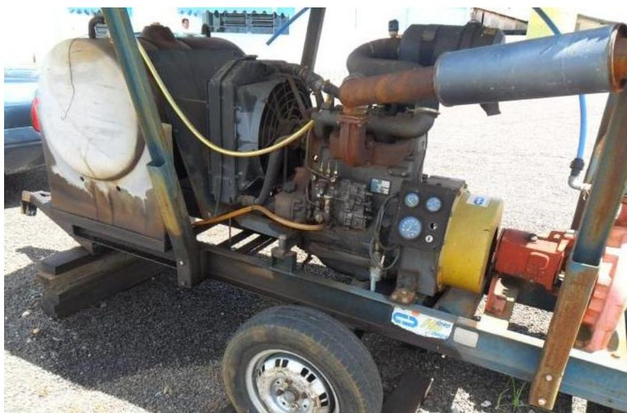
**Figura 54: Captação – moto-bomba estacionária utilizada na captação secundária.**
