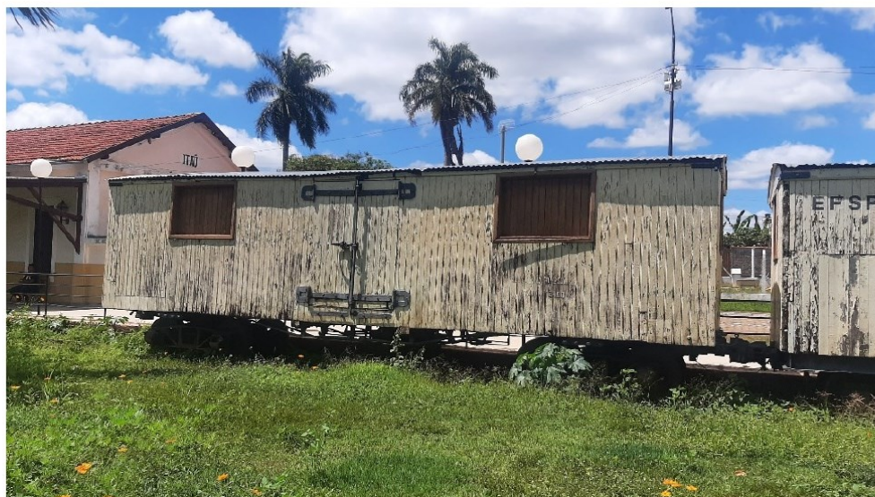
Foto 11 - Antigos Vagões da Cia Mogiana - Vista geral da lateral do vagão escritório - camada pictórica danificada. Dezembro/2022 - Foto: Fábio de Castro Alves
