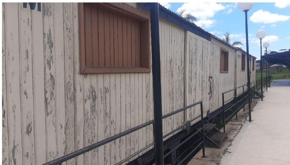
Foto 9 - Antigos Vagões da Cia Mogiana - Detalhe da lateral dos vagões - camada pictória danificada. Dezembro/2022 - Foto: Fábio de Castro Alves
