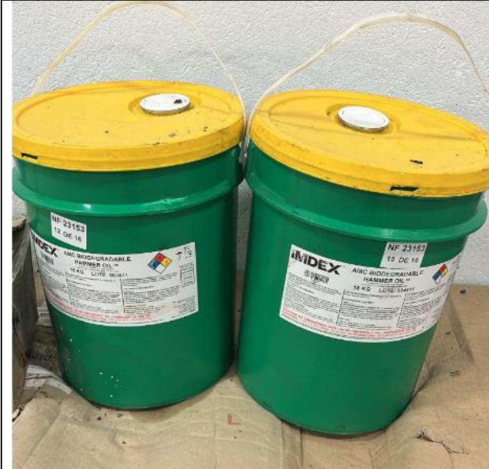
Oleo especial para perfuração de poço artesiano – convênio Caí de Baixo
