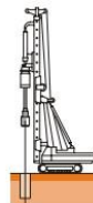
Estacas moldadas in loco escavadas mecanicamente. Estaca escavada a trado com lama betonítica: a utilização da lama betonítica durante o processo executivo ajuda a conferir estabilidade às escavações mais profundas.
