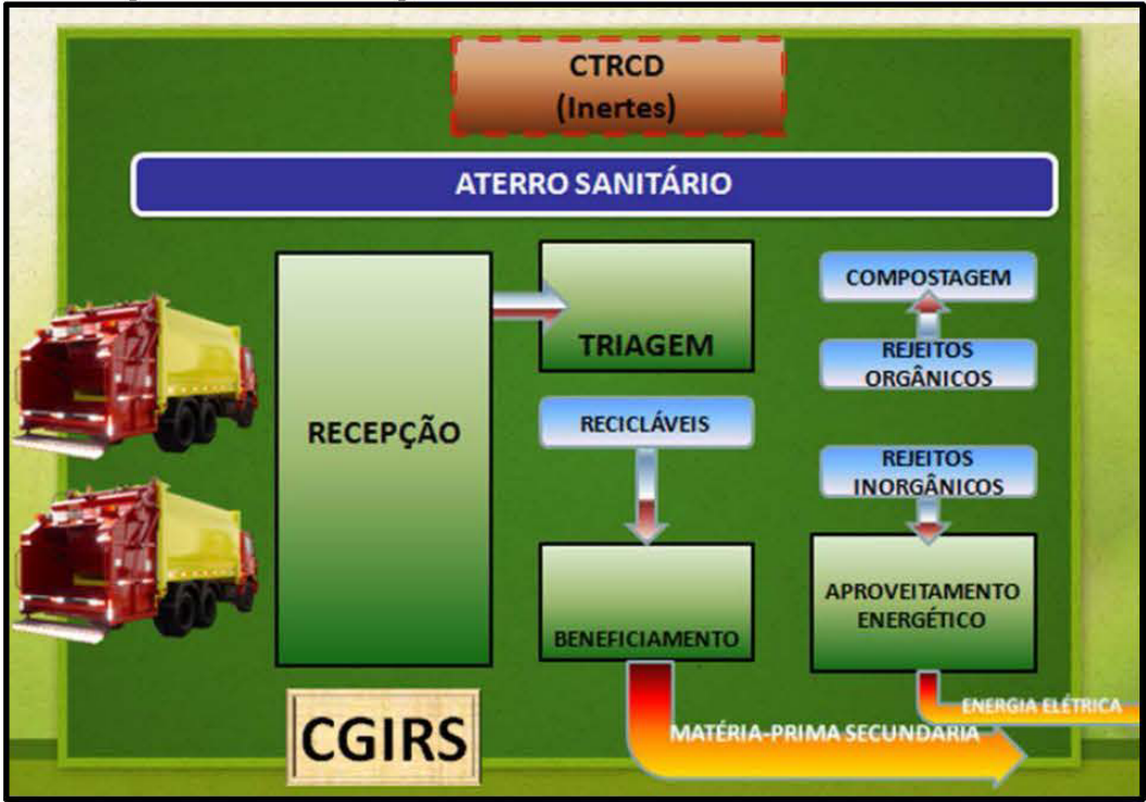
Figura 45. Centro de gerenciamento integrado de resíduos sólidos
