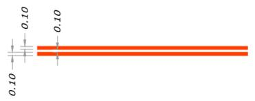
DETALHE - LINHA SECCIONADA AMARELA - 2,00 x 4,00 x 0,10m
