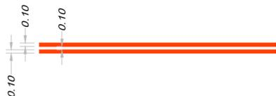
DETALHE - LINHA SECCIONADA AMARELA - 2,00 x 4,00 X 0,10m
