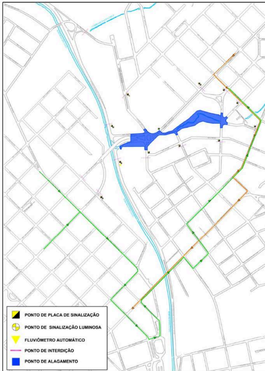
Figura 77 – Ponto crítico 02 – Equipamentos, dispositivos e rotas alternativas
